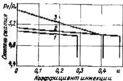
Рис. 3.2. Расчетные характеристики газоструйного эжектора (к примеру 3.4):  $p_p = 1100$  кПа;  $p_H = 2$  кПа;  $p_c = 10$  кПа; 1 — газоструйный компрессор с цилиндрической камерой смешения; 2, 3 — газоструйные эжекторы с конической камерой смешения и без диффузора
