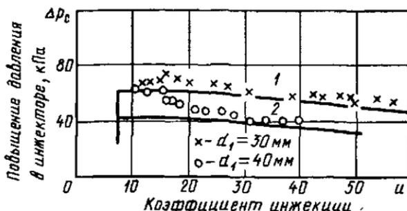
Рис. 9.20. Характеристики  $\Delta p_c = f(u)$  при различных диаметрах выходного сечения рабочего сопла:
