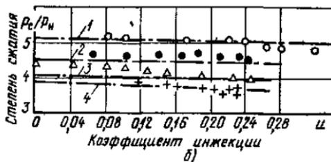
Рис. 3.25. Сравнение расчетных характеристик  $p_p/p_n = f(u)$  (штрих-пунктирные линии) с опытными при различных формах проточной части эжектора:
