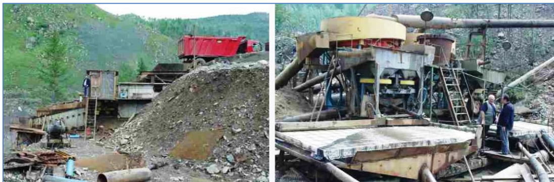
Вариант компоновки промывочного прибора в составе: грохота ГИТ-52 МБ (на фото слева), отсадочной машины ТРУД-12, стола СКО-7,5
