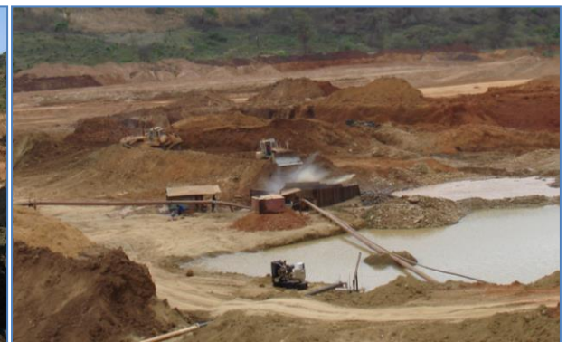
Киргизия, 2011, Акташ (Чаткал), ГРР, бутары ручные, одно- и двухоборотные
