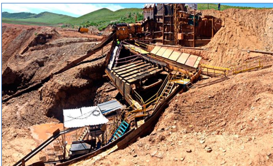
Промприбор СБШИ-100 в составе гидрогрохота, шлюзов глубокого и мелкого наполнения, шлюза с подвесными трафаретами и шлиходоводочной установки ШДУ-2
