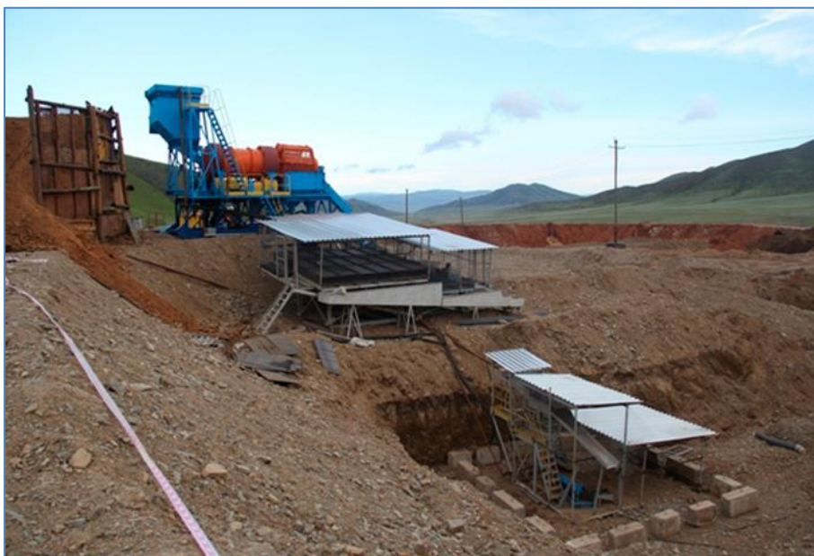
Промприбор СБШИ-100 в составе шлюзов глубокого и мелкого наполнения и шлиходоводочной установки ШДУ-2
