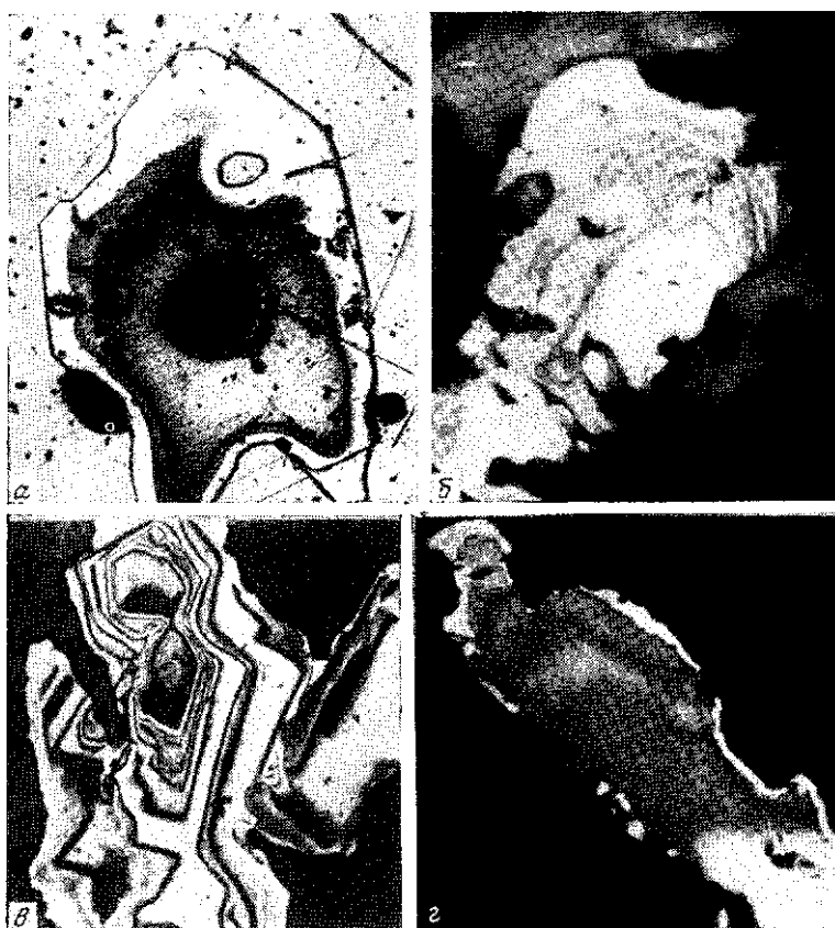
Фиг. 43. Зональность роста индивидов самородного золота; полирован, шлифы, — протравленные царской водкой (а — в) и CrO_3 + HCl (г)
