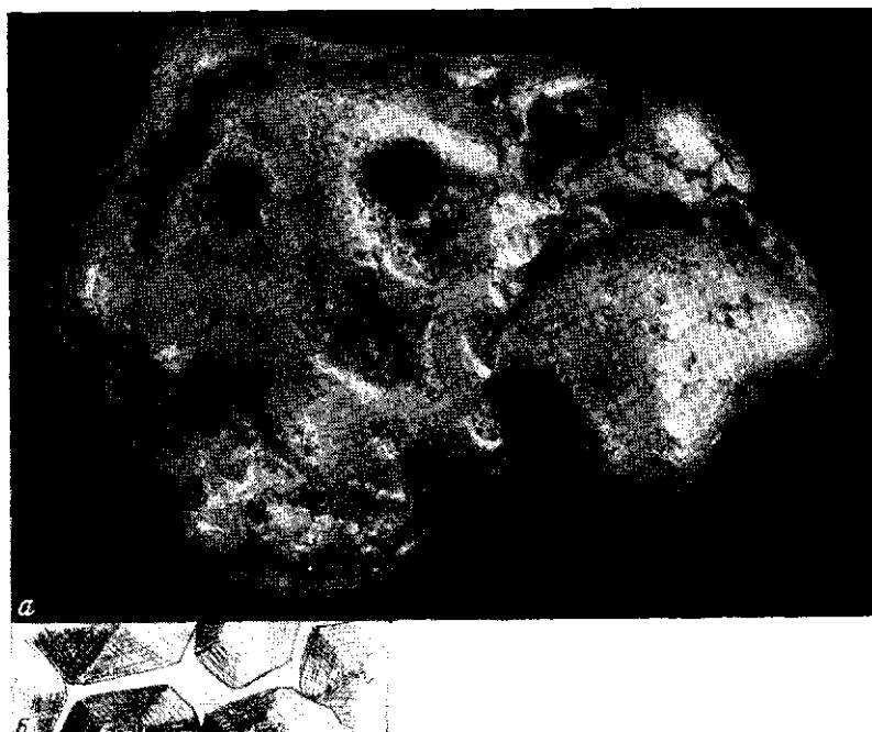
Фиг. 70. Скопления золота, разделенные зонами грубопористого строения; заметны отпечатки кристаллов пирита; увел. 1,5 (фото В. И. Соболевского); б — схематическая зарисовка шелевидной полости, разделяющей поля роста зерен в агрегатах золота; увел. 8
