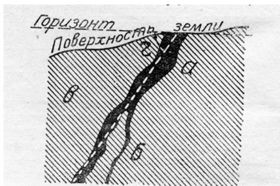
Рис. 16. a — рудная жила, б — прожилок, в — боковые породы, г — угол падения жилы.
