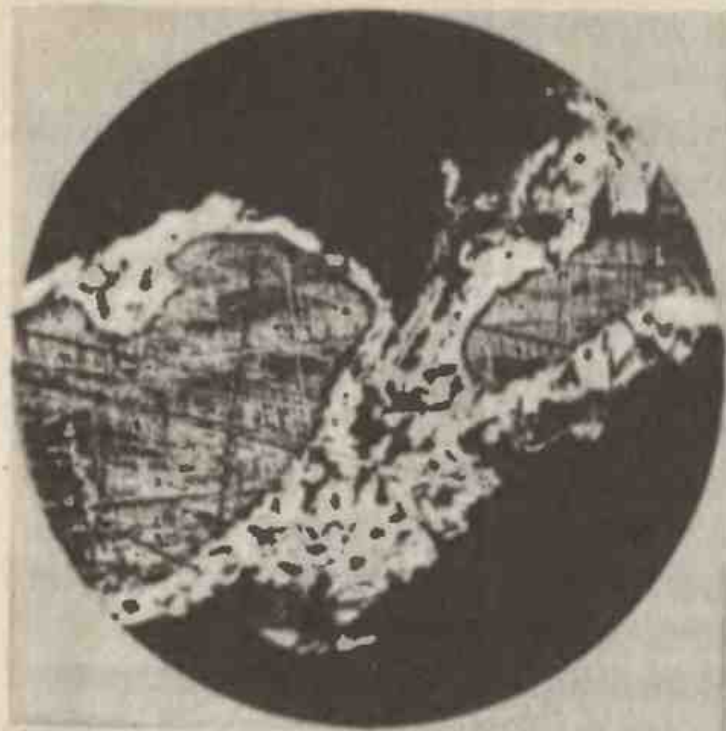
Рис. 28. Колломорфные наросты высокопробного вторичного золота (белое) на поверхности низкопробных золотинок (серое) из зоны окисления. Полированный срез золотинок, не подвергнутый травлению. Увел. 350
