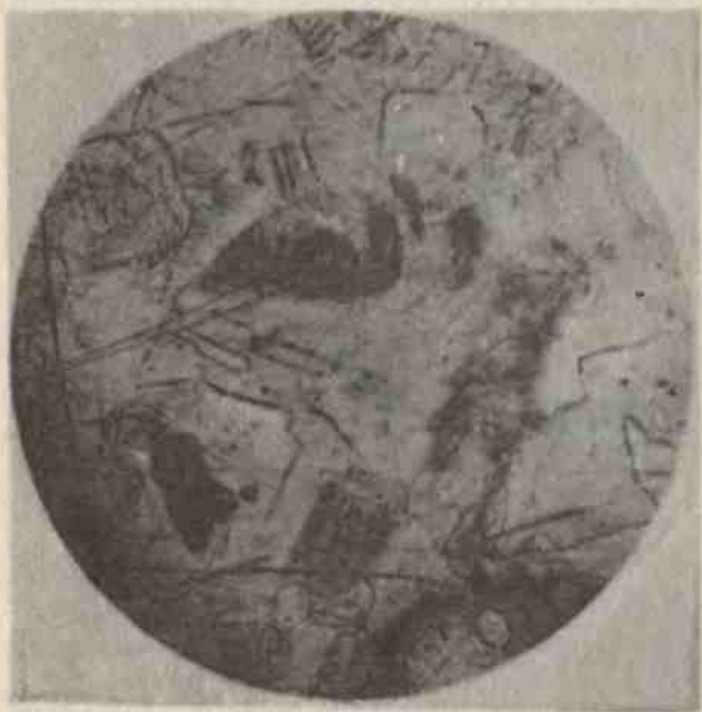
Рис. 34. Зоны трансляций в рекристаллизованных зернах золотинки из россыпи. Полированный срез, протравленный царской водкой. Увел. 130
