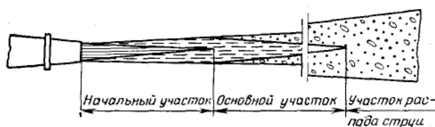
Рис. 75. Схема строения гидромониторной струи
