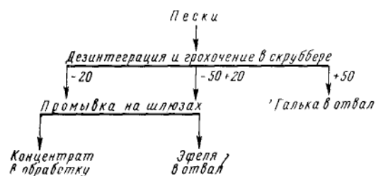
Рис. 149. Технологическая схема промывочного прибора ПКС-1-700
