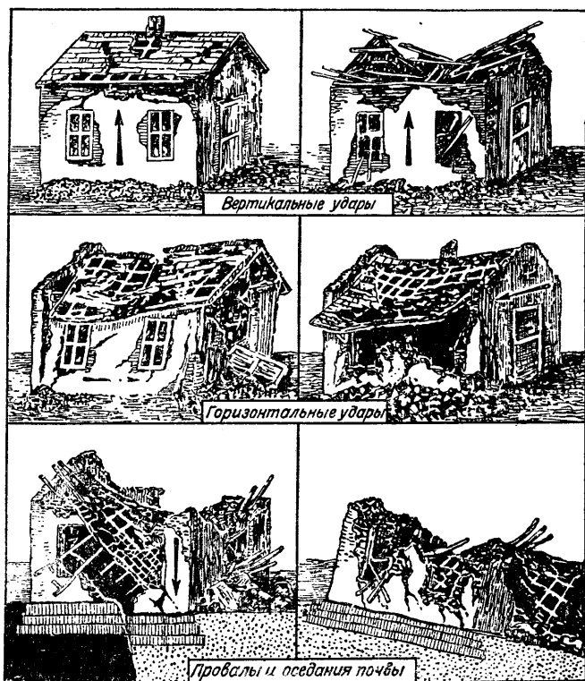
Рис. 221. Зависимость разрушений от направления ударов.
